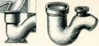
Fig. F Siphon intercepteur
